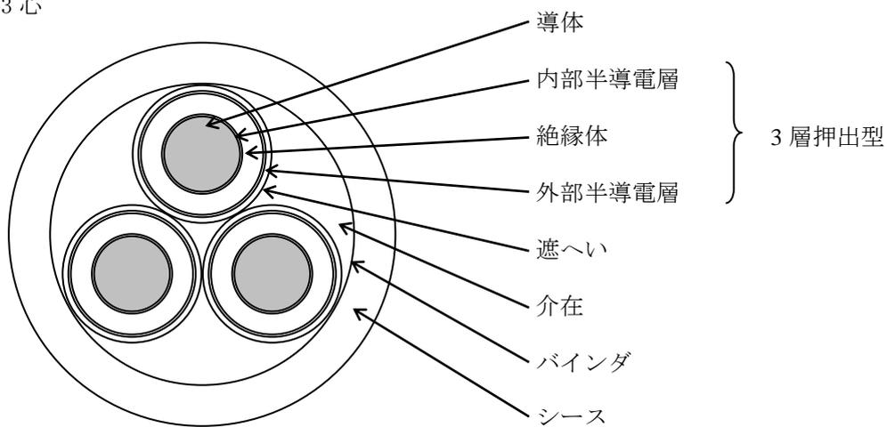
付表 6600V 架橋ポリエチレン絶縁ビニルシースケーブル(3層押出型) (6600V CV(EE))
