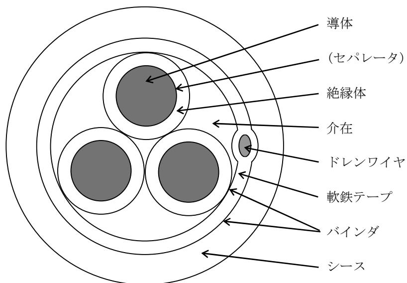
付表 600V 架橋ポリエチレン絶縁ビニルシースノイレックスケーブル(600V CV-S(E))
