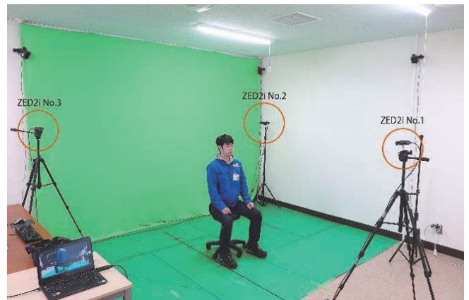
図6 ADTPS™の立体データ化システム構成
