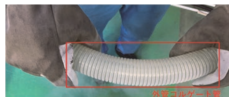
図3 液体窒素浸漬後の外管コルゲート管の曲げ試験
