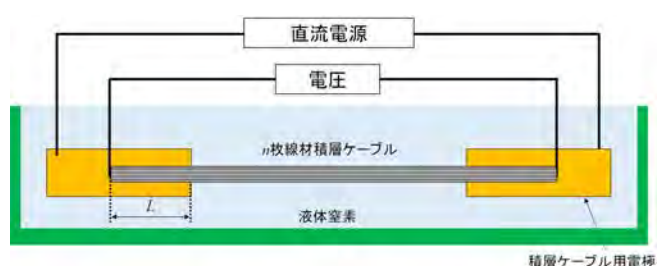
図5 電極を付けた積層型超電導ケーブル通電試験の概要
