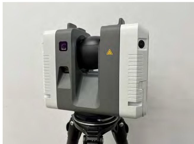
図1 ライカジオシステムズ社 RTC360
