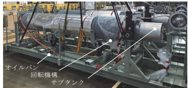
図 3 専用運搬架台の構造
