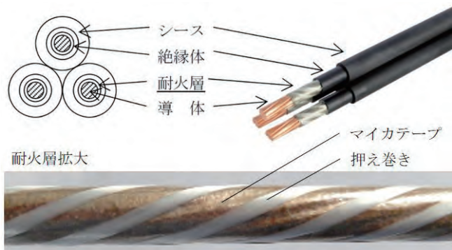
図3 耐火ケーブルの構造
