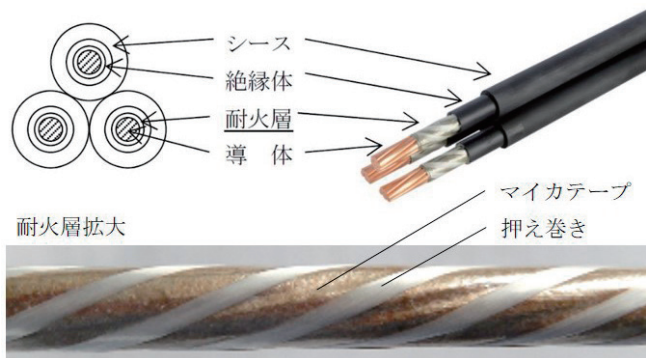
図3 耐火ケーブルの構造
