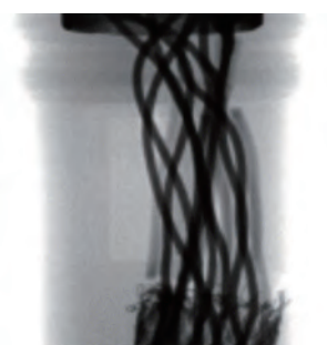
図7 X線写真（対撚りの乱れ，偏り）
