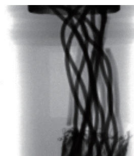
図7 X線写真（対撚りの乱れ、偏り）
