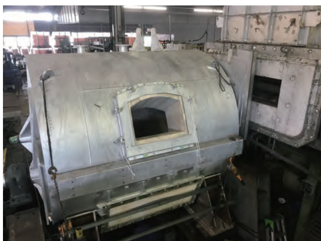
図3 溶解炉 #2 炉体更新
