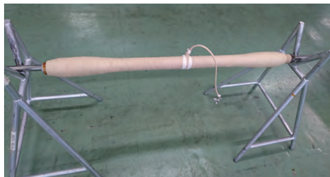
図3 中間接続部モデル
