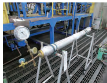
図3 補修実験後加圧放置（半年）状況
