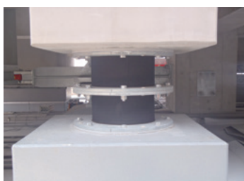
図 3 減災館の地震体験設備に設置された復元ゴム
