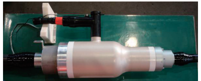
図 3 特別高圧同軸ケーブル用接続部外観
