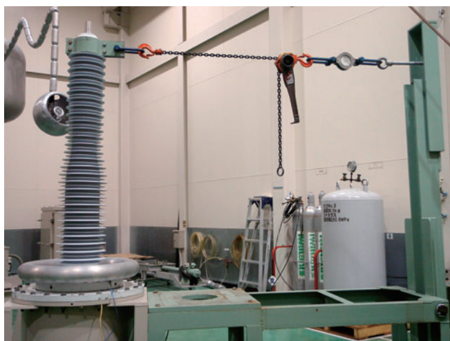
図8 曲げ耐荷重試験
