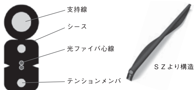
図 2 ドロップ光ケーブル断面構造と SZ ケーブル構造
