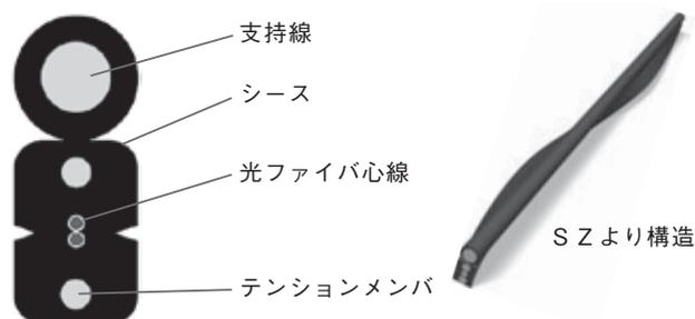
図 2 ドロップ光ケーブル断面構造と SZ ケーブル構造
