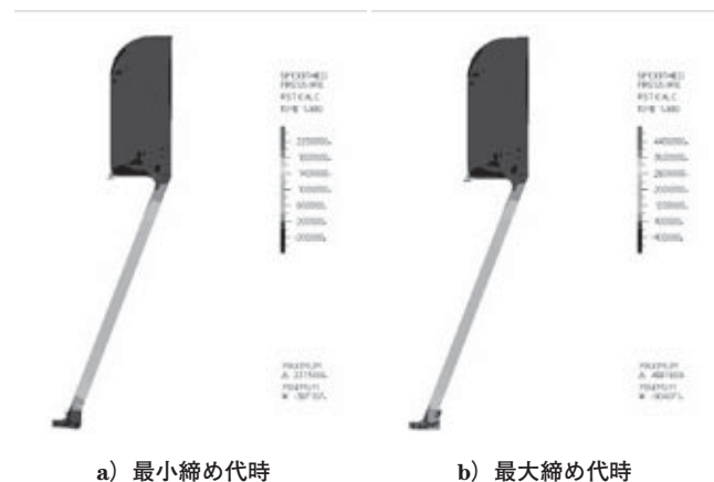
図6 固体絶縁接続界面の面圧シミュレーション
