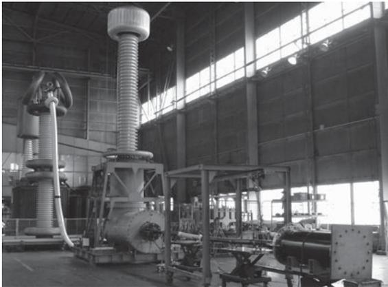
図8 商用周波部分放電，耐電圧試験
