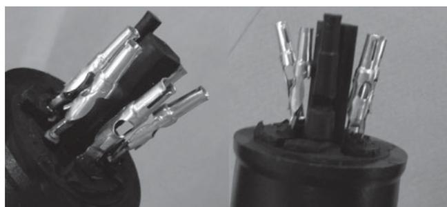
図9 プラグ内部(塩水噴霧試験後)
