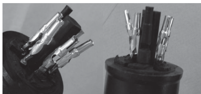
図9 プラグ内部(塩水噴霧試験後)
