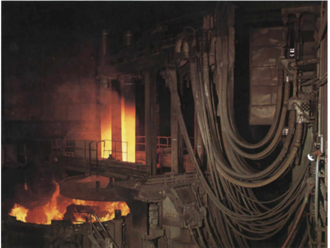
現在製鋼用アーク炉，誘導溶解炉をはじめ，各種の電気炉に水冷ケーブルが数多く使用されていますが，SWCCは水冷ケーブルのトップメーカーとして豊富な経験と実績，研究をベースに優れた製品を提供しています。
