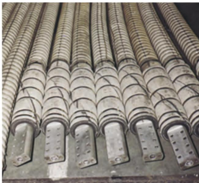
アーク炉用水冷ケーブルの外観
