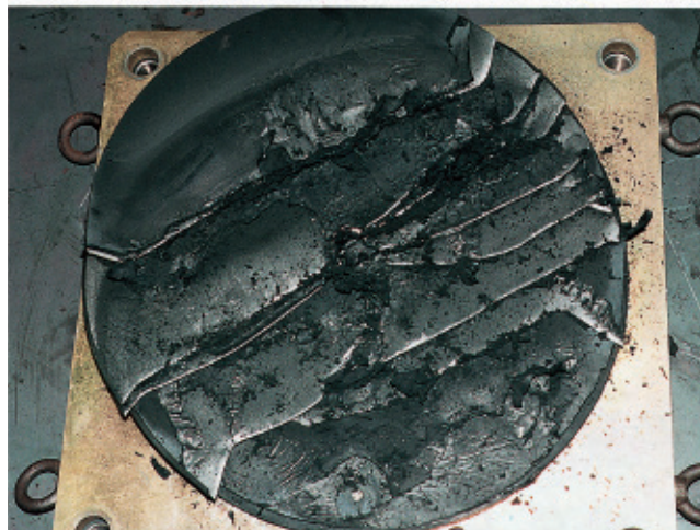
免震アイソレータの破断面(常用荷重の10倍以上の約30,000kNで破断しました)
