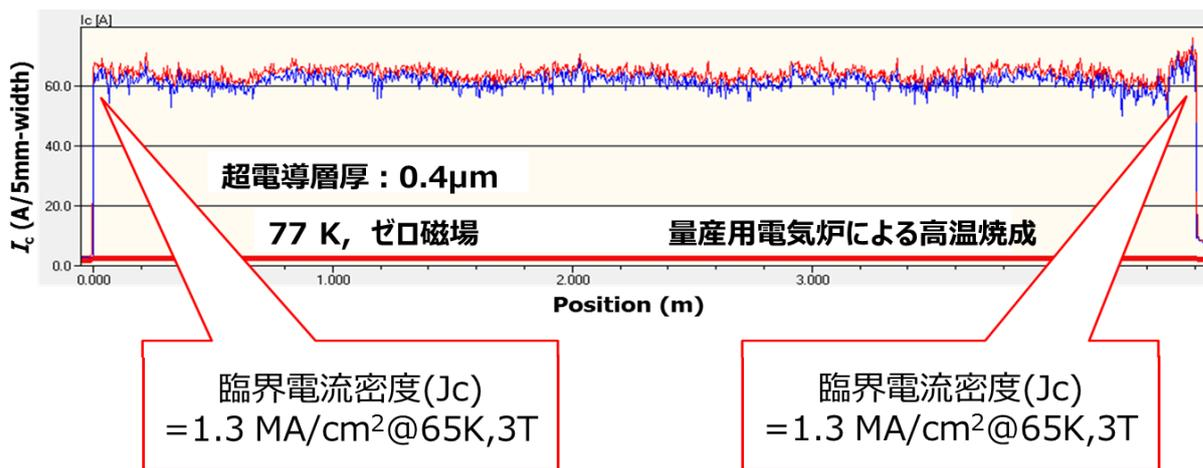
図 5 基本原理検証時の条件で作製した 5 m 線材の特性
