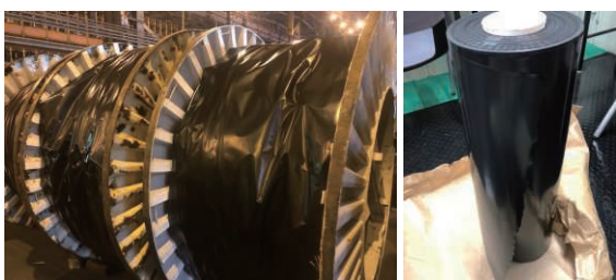
製品ドラムに巻かれた包装材(黒色シート) 再生プラスチックシート
