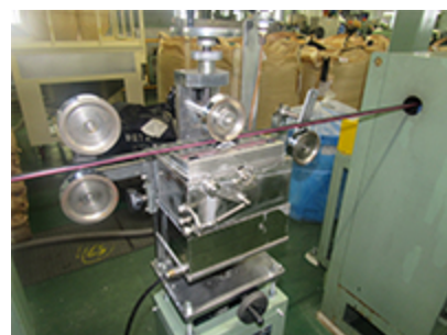
600V CVケーブルの印刷工程
