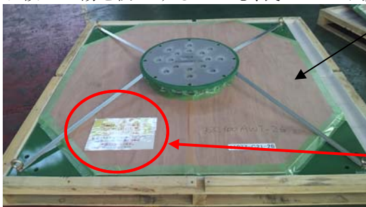
養生ベニヤの取付例
