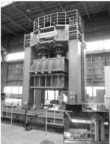
図1 35 MN圧縮せん断試験機全景
